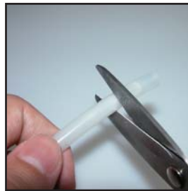
5. Coupez la section inutile et assurez-vous que le bord de coupe est lisse. Ne le coupez pas trop court.
