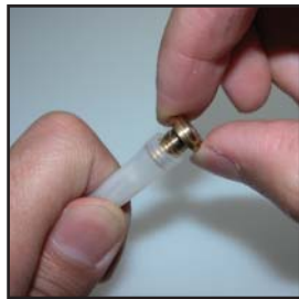
4. Enlevez le joint intérieur de sûreté du tube de silicium.
