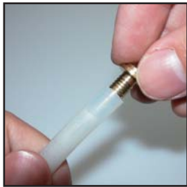
6. Placez en arrière le joint intérieur de sûreté au tube.
