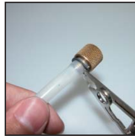
7. Befestigungsstück wieder an Schlauchende setzen. C-Ring zurück zur Ausgangsposition schieben; dieser dient zur zusätzlichen Sicherung des Schlauches.
